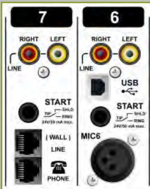
Les modules 5 & 6 offrent une entrée Micro (XLR) ; une entrée stéréo Ligne (RCA) et une connexion USB pour un transfert audio depuis/vers un PC.
