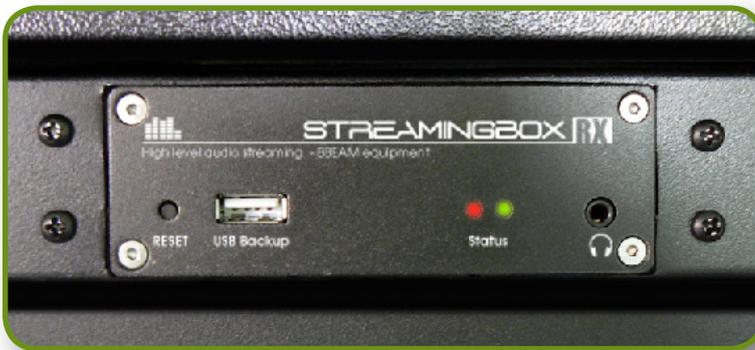
Fournies en version 19", les streamingbox TX et RX assurent un flux audio à faible latence de haute qualité et sans interruption. Combinées à la puissance des paraboles, vous créez votre propre réseau sur IP totalement configurable.
