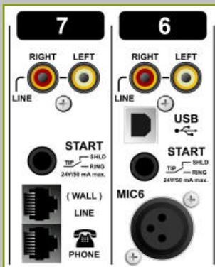
Les modules 5 & 6 offrent une entrée Micro (XLR) ; une entrée stéréo Ligne (RCA) et une connexion USB pour un transfert audio depuis/vers un PC.
