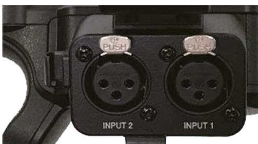
La poignée robuste et détachable facilite le transport du caméscope et facilite également les prises de vue sous un angle faible, grâce au bouton REC intégré avec fonction de verrouillage et au levier de zoom. Les entrées audio XLR sont fournies pour la connexion d'un microphone professionnel ou pour une entrée LINE, avec possibilité d'alimentation Phantom.
